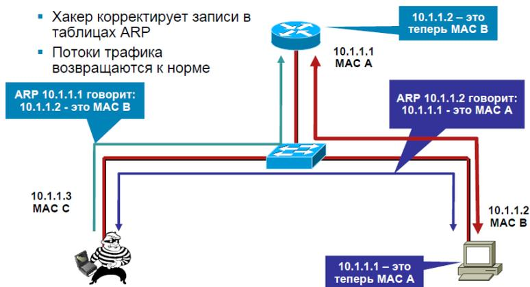
Рис.95 «Заметание» следов, коррекция таблиц
