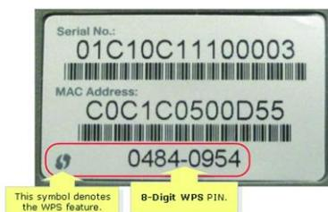
Рис.118 PIN-код для подключения по WPS
